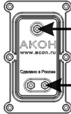
ПОДКЛЮЧЕНИЕ КАБЕЛЯ К КОМБО-ЭЛЕКТРОДУ Cu/Ag и ЭЛЕКТРОДУ МЕДИ Cu в SilverPRO LIGHT SPL3.2
