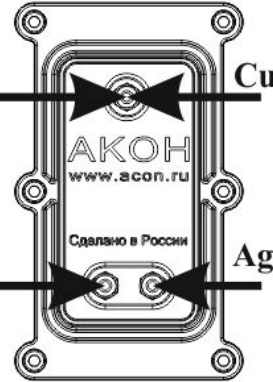
ПОДКЛЮЧЕНИЕ КАБЕЛЯ К КОМБО-ЭЛЕКТРОДУ Cu/Ag и ЭЛЕКТРОДУ МЕДИ Cu в SilverPRO LIGHT SPL3.2
